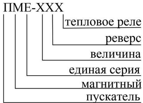
теплого реле – 1, с тепловым реле – 2, нереверсивный – 1, реверсивный – 2.
